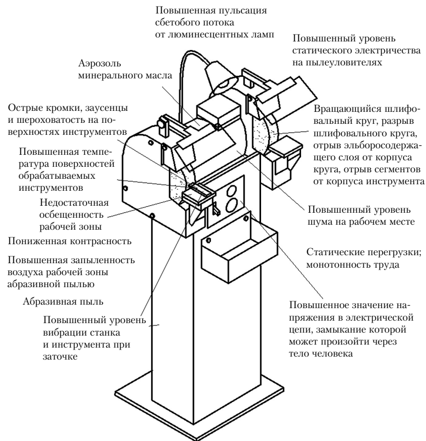
Рис. 2.1. Опасные и вредные производственные факторы при заточке режущего инструмента
