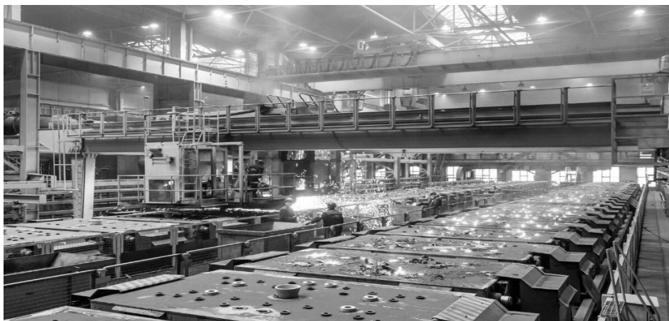
Рис. 6.7. Система естественного освещения литейного цеха
