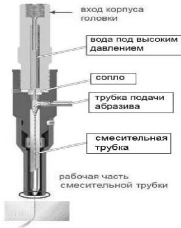
Рис. 23. Устройство режущей головки
