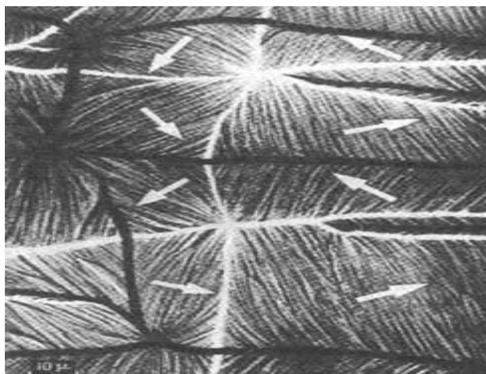
Рис. 2.22. Электронно-микроскопическое изображение доменной структуры пермаллоя - сплава никеля с железом
