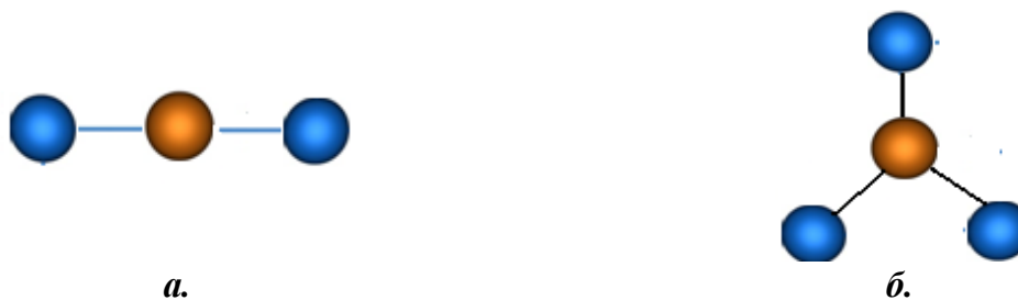
Рис. 53. Линейная структура комплекса с КЧ=2 ( sp -гибридизация) (а) и плоско-треугольная структура комплекса с КЧ=3 ( sp^2 -гибридизация) (б)
