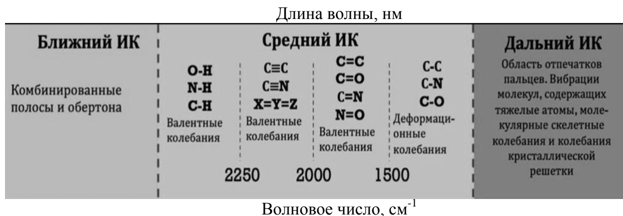
Рис. 2.12. Основные положения поглощения одинарных, двойных и тройных связей органических соединений
