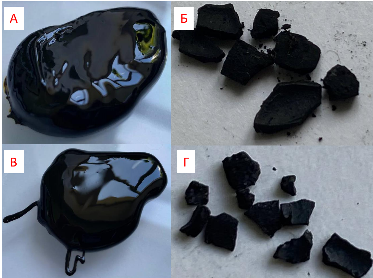
Рисунок 17. А – кубовый остаток плазмохимического пиролиза смеси мазута с водой (15%масс.), Б – твердый продукт после экстракции гептаном и фильтрации (15%масс.).
