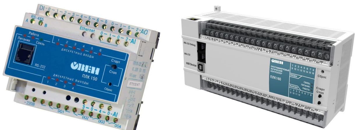
а) б) Рис. 1.2. Внешний вид контроллера: а – ОВЕН ПЛК 150; б – ОВЕН ПЛК 160
