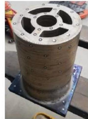
Процесс аддитивного производства изделий из порошков
