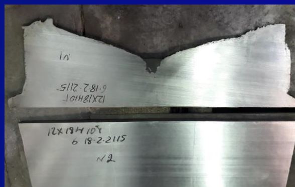
Разрез полученного слитка
