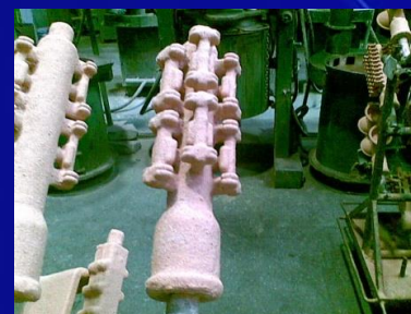
Оболочковая форма с применением техногенных отходов
