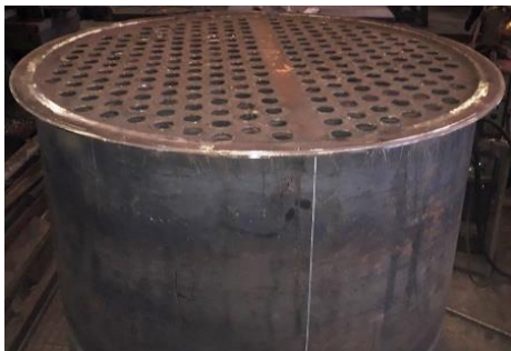
Кожухотрубный теплообменник для охлаждения и очистки ваграночных газов
