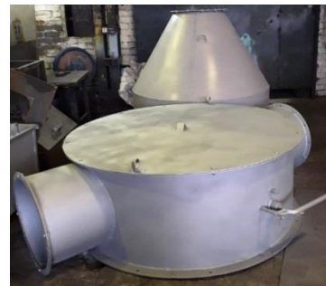
Кожухотрубный теплообменник для охлаждения и очистки ваграночных газов
