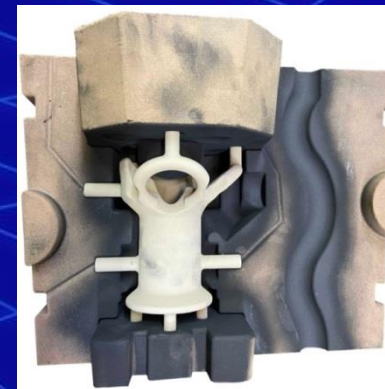
Комбинированная литейная форма, полученная по разработанной технологии
