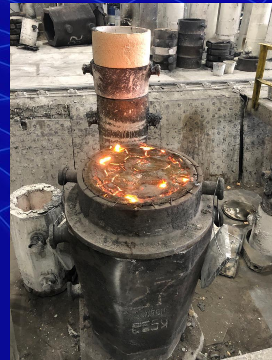
Залитая изложница 5-ти тонного кузнечного слитка с применением разработанного состава экзотермической смеси
