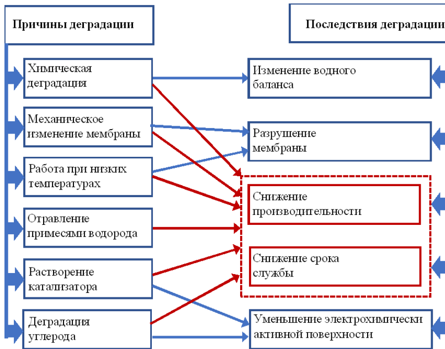
Структурная схема, поясняющая причины и последствия деградации топливных элементов.
