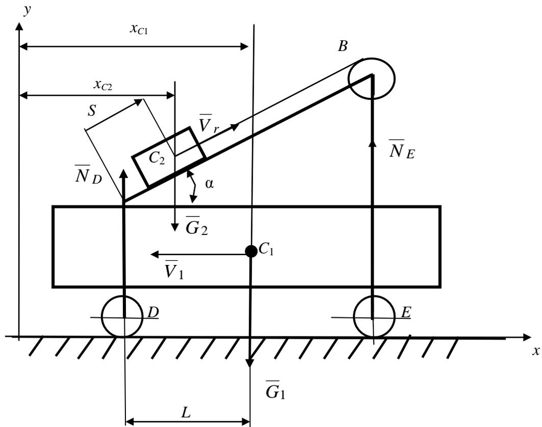
Рис. 32. Механическая система из подвижной платформы и груза
