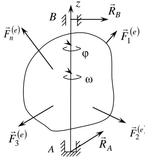
Рис. 17. Вращение твердого тела вокруг неподвижной оси
