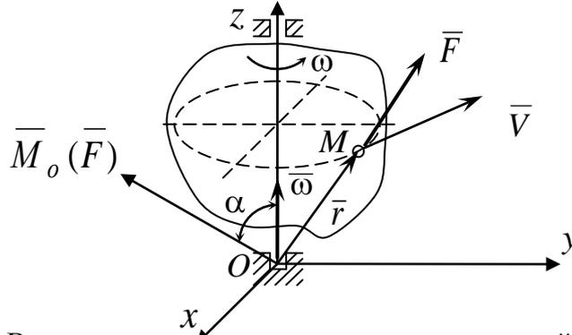
Рис. 25. Вращение твердого тела вокруг неподвижной оси
