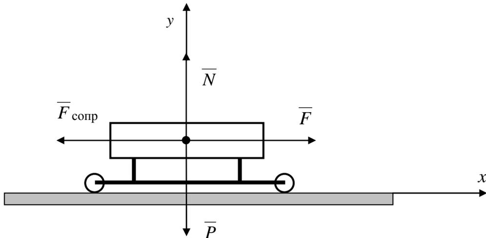
Рис. 30. Движение вагона под действием силы  $\bar{F}$
