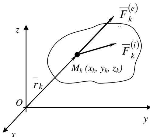
Рис. 12. Внешние и внутренние силы механической системы
