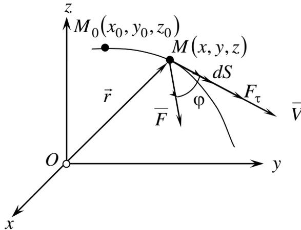
Рис. 19. Движение материальной точки под действием силы  $\vec{F}$
