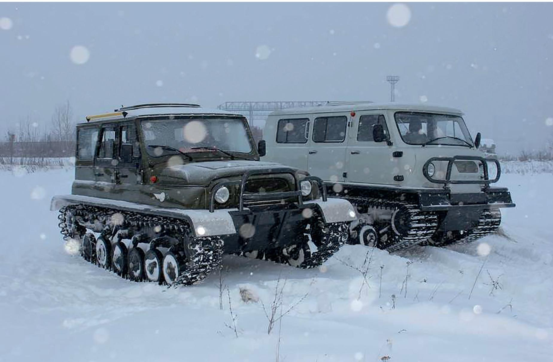
Испытание подвижности гусеничного плавающего снегоболотохода «Ухтыш», разработанного в НИЛ Транспортных машин и транспортно-технологических комплексов ИТС НГТУ
