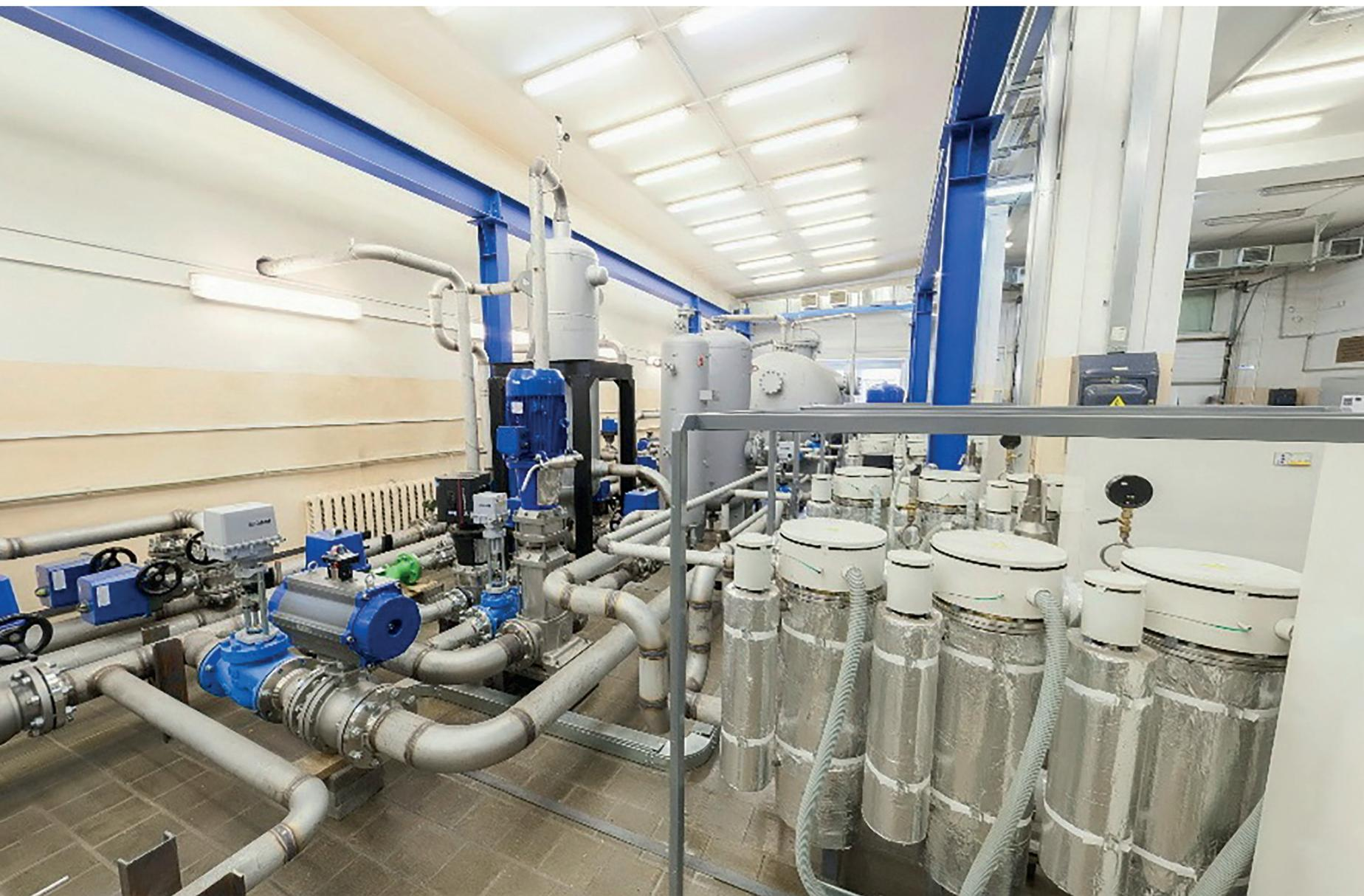
Экспериментальный стенд ФТ-40 для исследования процессов турбулентного смешения потоков теплоносителя в полях внешних массовых сил НИЛ «Реакторная гидродинамика» ИЯЭиФ НГТУ
