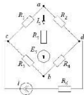
$j = 1 \text{ А}; E_5 = 1 \text{ В}; R_1 = 1 \text{ Ом}; R_2 = 2 \text{ Ом}; R_3 = 3 \text{ Ом}; R_4 = 4 \text{ Ом}; R_5 = 0,6 \text{ Ом}; R_6 = 3 \text{ Ом}$
