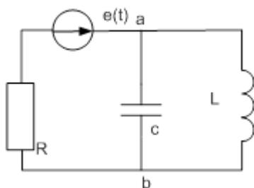
$$e(t)=120*\sin(\omega t+35); L=0,025 \text{ Гн}, C=630 \text{ мкФ}, R=6 \text{ Ом}, f=50 \text{ Гц}.$$
