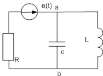
$$e(t) = 120 \cdot \sin(\omega t + 35); L = 0,025 \text{ Гн}, C = 630 \text{ мкФ}, R = 6 \text{ Ом}, f = 50 \text{ Гц}.$$
