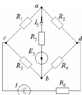
$j = 1 \text{ A}$ ;  $E5 = 1 \text{ B}$ ;  $R1 = 1 \text{ Ом}$ ;  $R2 = 2 \text{ Ом}$ ;  $R3 = 3 \text{ Ом}$ ;  $R4 = 4 \text{ Ом}$ ;  $R5 = 0,6 \text{ Ом}$ ;  $R6 = 3 \text{ Ом}$
