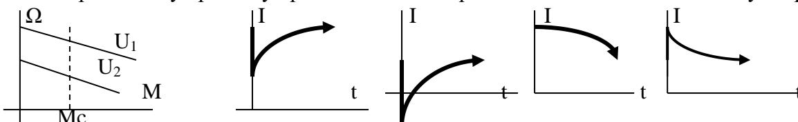
47. Переходному процессу при изменении напряжения с  $U_2$  до  $U_1$  соответствует кривая
