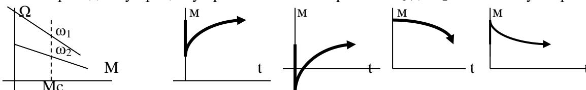
49. Переходному процессу при изменении напряжения с  $\omega_2$  до  $\omega_1$  соответствует кривая
