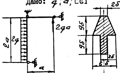
**Задача 2.** Для указанной точки А вычислить напряжения, показать напряженное состояние элемента в этой точке и составить для него условие прочности.
