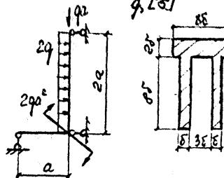
**Задача 2.** Для опасной точки бруса вычислить напряжения, показать напряженное состояние и записать условие прочности.
