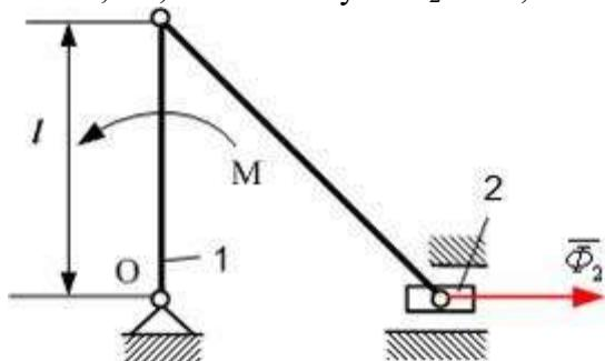
При использовании общего уравнения динамики модуль момента  $M$  пары сил, действующих на кривошип 1, равен...
