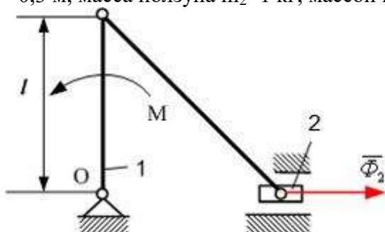
При использовании общего уравнения динамики модуль момента М пары сил, действующих на кривошип 1, равен...
