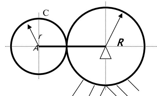
В плоской передаче кривошип  $OA$  вращается с  $\omega_{OA} = 5\text{с}^{-1} = \text{const}$ . Радиусы большой  $R = 30\text{см}$  и малой  $r = 20\text{см}$  шестеренок.
