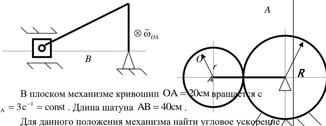
В плоском механизме кривошип  $OA = 20\text{см}$  вращается с  $\omega_{OA} = 3\text{с}^{-1} = \text{const}$ . Длина шатуна  $AB = 40\text{см}$ .
