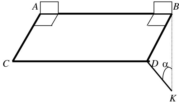
Полка весом  $P_{ABCD} = 120\text{Н}$ ,  $AC = 30\text{см}$ ,  $AB = 40\text{см}$ ,  $\alpha = 30^\circ$  находится в равновесии в горизонтальном положении.
