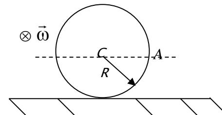
Диск радиуса  $R = 2\text{м}$  равномерно катится с угловой скоростью
