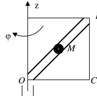
Квадратная рамка вращается вокруг оси  $z$  по закону  $\varphi = 8\pi t^2$  рад. Вдоль выреза  $OB$  движется точка  $M$  по закону  $OM = 2\sin \frac{\pi}{3}t \text{ см}$ .
