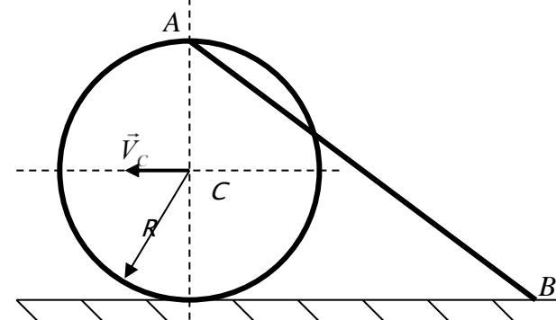
Плоский механизм состоит из диска  $R=2\text{м}$  и стержня  $AB=8\text{м}$  соединенным с ним шарниром А. Диск катится равномерно  $V_C = 6 \frac{\text{м}}{\text{с}}$ .
