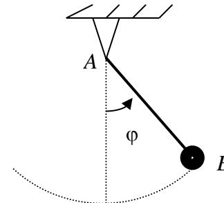
Точка подвешенная на стержне  $AB = 50\text{cm}$  качается около положения равновесия по закону  $\varphi = \frac{\pi}{6} \sin \frac{\pi t}{3}$  рад.
