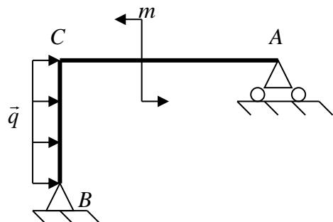
Балка АСВ с размерами  $AC = 5\text{м}$ ,  $BC = 3\text{м}$  нагружена парой
