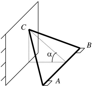
Треугольная пластина веса  $P_{ABC} = 60\text{Н}$ ,  $AB = BC = 40\text{см}$ ,  $\alpha = 30^\circ$ , угол  $ACB = 60^\circ$  опирается в точке С на вертикальную стенку, а в углы А и В закреплены петлями.
