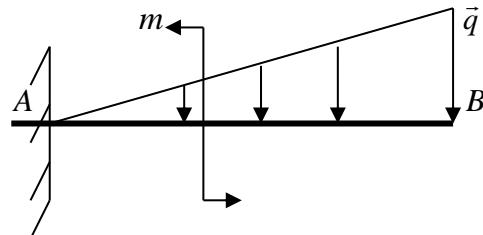
Балка  $AB = 6\text{м}$  нагружена парой сил с  $m = 3\text{Нм}$  и линейной
