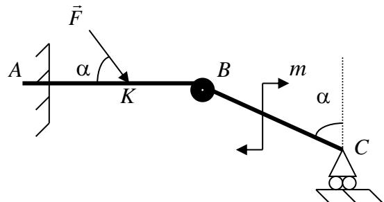
Составная балка  $ABC$  нагружена силой  $F=5\text{Н}$  и парой сил с моментом  $m=7\text{Нм}$ .
