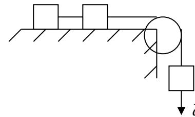
Система трех одинаковых грузов, связанных нитью, движется с ускорением  $a = 0.2g$ . Определить коэффициент трения скольжения между горизонтальной опорной плоскостью и грузами. Массой блока пренебречь.
