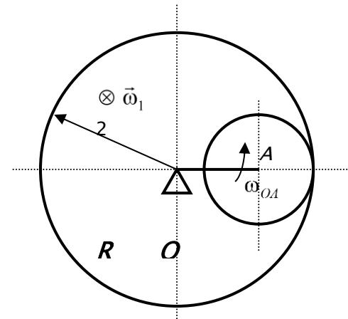
В плоской передаче кривошип  $OA = 20\text{см}$  вращается с  $\omega_{OA} = 2\text{с}^{-1}$ . Колесо 1 радиуса  $R = 30\text{см}$  вращается с угловой
