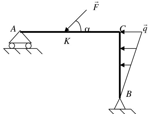
Балка  $ACB$  нагружена силой  $F = 30\text{Н}$  и распределенной нагрузкой  $q = 5 \frac{\text{Н}}{\text{м}}$ ,  $AC = 25\text{см}$ ,  $CB = 18\text{см}$ ,  $CK = 15\text{см}$ ,  $\alpha = 60^\circ$ .
