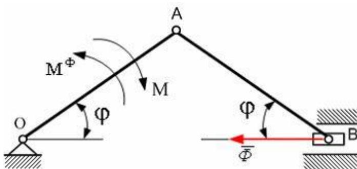
При использовании общего уравнения динамики модуль момента  $M$  пары сил, действующей на кривошип OA, равен...
