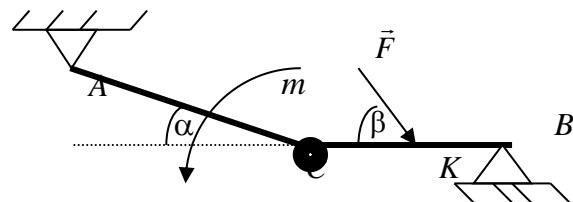
Составная балка  $ACB$  нагружена силой  $F = 60\text{Н}$ ,  $m = 8\text{Нм}$ ,  $CK = 20\text{см}$ ,  $AC = 50\text{см}$ ,  $CB = 40\text{см}$ ,  $\alpha = 30^\circ$ ,  $\beta = 60^\circ$
