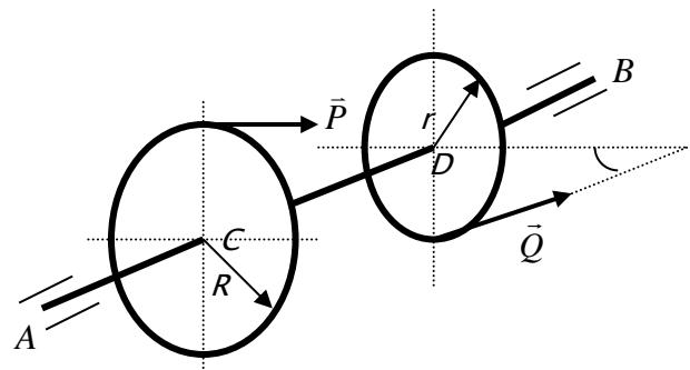
На вал насажены два диска  $C$  и  $D$ . Найти реакции в подшипниках  $A$ ,  $B$  и силу  $Q$ , если известно, что  $AC = BD = 20\text{ см}$ ,  $\alpha = 30^\circ$ ,  $P_C = 60\text{ Н}$ ,  $P_D = 40\text{ Н}$ ,  $CD = 30\text{ см}$ ,  $R = 1.5r$  при равновесии вала.
