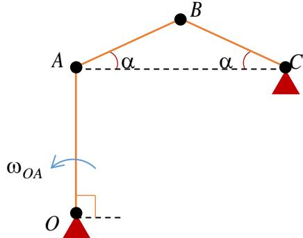
Определить для данного положения плоского механизма  $OABC$  скорость промежуточного шарнира  $B$  и угловые скорости всех звеньев при следующих данных:  $\alpha = 30^\circ$ ,  $OA = 0.2 \text{ м}$ ,  $\omega_{OA} = 2 \frac{\text{рад}}{\text{с}}$ .
