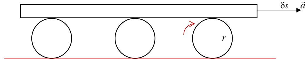
Доску массы  $M$ , лежащую на трех одинаковых катках массы  $m$  и радиуса  $r$  каждый, тянут горизонтально сообщая ей ускорение  $\vec{a}$ . Определить обобщенную силу от сил инерций на перемещении доски  $\delta s$ .
