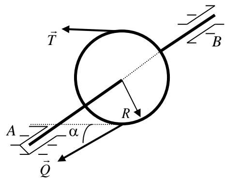
Диск веса  $P_{\text{диска}} = 20\text{Н}$  и радиуса  $R = 10\text{см}$  насажен на вал  $AB$ , На диск действуют силы  $Q = 30\text{Н}$  и  $T$ ,  $AC = 40\text{см}$ ,  $CB = 30\text{см}$ ,  $\alpha = 30^\circ$ .
