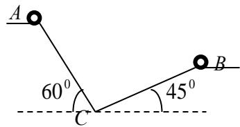
Точка массы  $m = 2\text{ кг}$ , двигаясь под действием силы тяжести, попадает из положения  $A$  в положение  $B$ .
