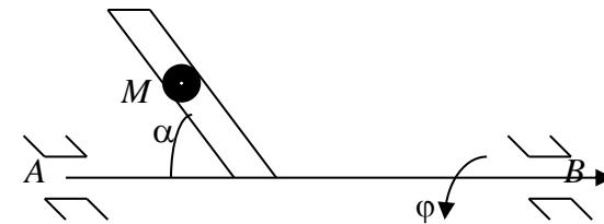
Трубка приваренная под углом  $\alpha$  к горизонтальному валу  $AB$  вращается по закону  $\varphi = 2\pi t^2$ . Внутри трубы движется шарик  $M$  по закону  $OM = 2 \cos \frac{\pi}{3} \text{см}$ .
