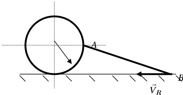
Плоский механизм состоит из диска  $R = 20\text{см}$  и стержня  $AB = 100\text{см}$ , соединенного с ним шарниром  $A$ . В данном положении известна скорость конца  $B$  стержня  $V_B = 8 \frac{\text{м}}{\text{с}}$ .
