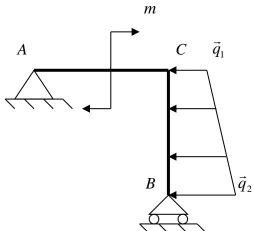
Балка  $ACB$  нагружена парой сил с моментом  $m = 3\text{Нм}$  и распределенной нагрузкой  $q_1 = 4 \frac{\text{Н}}{\text{м}}$ ,  $q_2 = 6 \frac{\text{Н}}{\text{м}}$ ,  $CB = 3\text{м}$ ,
