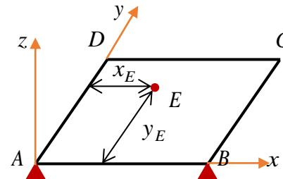
Прямоугольная плита  $ABCD$  лежит на трех точечных опорах  $A$ ,  $B$  и  $E$ . Определить координаты опоры  $E$ , чтобы плита оставалась в равновесии при следующих данных:  $P_{ABCD} = P$ ,  $N_A = \frac{P}{4}$ ,  $N_B = \frac{P}{5}$ ,  $AB = b$ ,  $BC = c$ .
