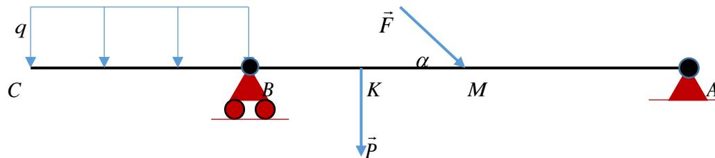
Балка  $ABC$  находится в равновесии под действием двух сосредоточенных сил и равномерно-распределенной нагрузки на участке  $CB$ . Определить реакции в шарниро – подвижной опоре  $B$  и шарниро – неподвижной опоре  $A$  если  $q = 3 \frac{kH}{m}$ ,  $P = 8 \text{ кН}$ ,  $F = 6 \text{ кН}$ ,  $\alpha = 45^0$ ,  $AM = BC = 2 \text{ м}$ ,  $BK = KM = 1 \text{ м}$ .
