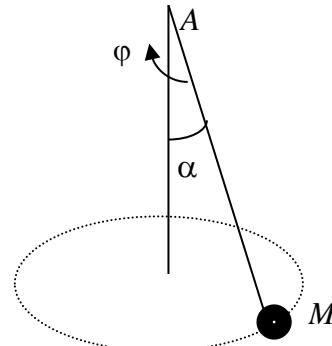
Шарик  $M$  подвешен на нити  $AM = 3\text{м}$ ,  $\alpha = 30^\circ$ , вращается по закону  $\varphi = \frac{\pi}{3}t$  рад и описывает окружность в горизонтальной плоскости.
