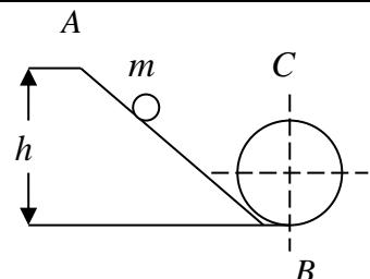
По наклонному пути  $AB$ , образующего затем петлю в виде кольца  $BC$  радиуса  $r$ , скатывается груз массы  $m$ . С какой высоты  $h$  нужно пустить груз без начальной скорости, чтобы он мог дойти до точки  $C$  внутри кольца, не отделяясь от него?
