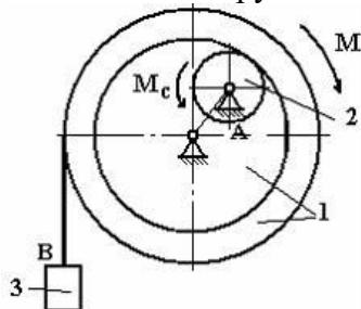
Отношение возможных перемещений точек **A** и **B** равно  $(\frac{\delta S_A}{\delta S_B} = \dots)$
