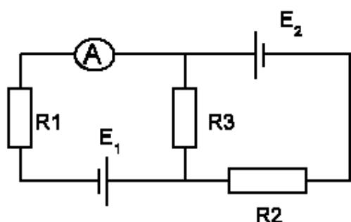
2. Батареи имеют ЭДС:  $E_1=2$  В,  $E_2=4$  В. Сопротивление  $R_1 = 0,5$  Ом. Напряжение на сопротивлении  $R_2$  равно 1В, при этом ток протекает через него справа налево. Найти показания амперметра.
