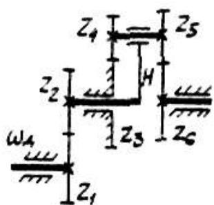
Для заданного зубчатого механизма определить передаточное отношение аналитическим методом.
