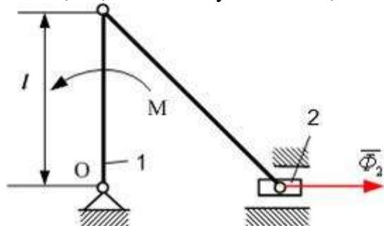
При использовании общего уравнения динамики модуль момента  $M$  пары сил, действующих на кривошип 1, равен...
