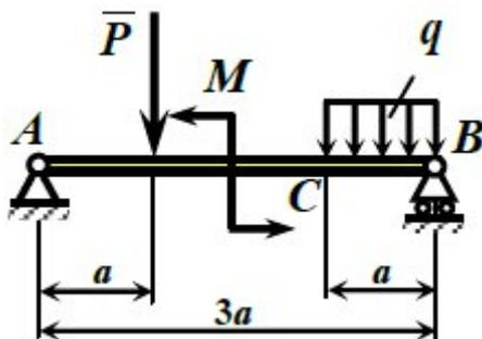
Определить реакции опор балки  $AB$ , находящейся под действием равномерно распределенной нагрузки с интенсивностью  $q = 1,2$  кН/м, сосредоточенной силы  $P = 1,7$  кН и пары сил с моментом  $M = 2$  кН·м, если,  $a = 3$  м.
