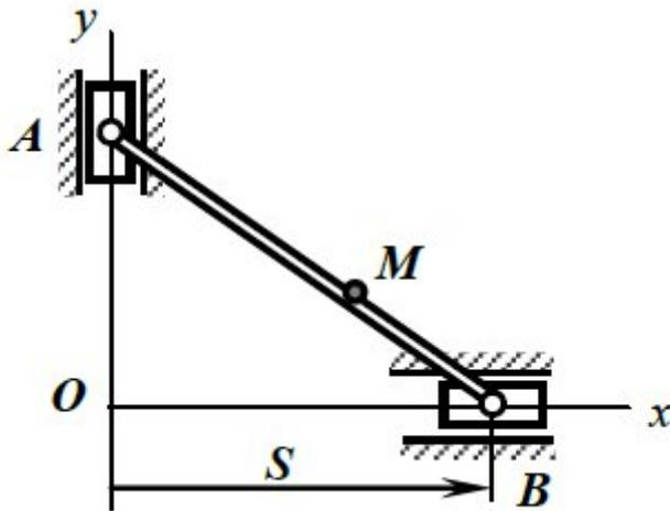
Точка  $B$  механизма движется по закону  $S = 0,45\sin 3\pi t$  ( $S$  – м,  $t$  – с). Построить положение звеньев механизма в моменты времени  $t_0 = 0$ ,  $t_1 = \frac{1}{18}$  с и  $t_2 = \frac{1}{6}$  с. Написать уравнения движения точек  $A$  и  $M$  механизма в координатной форме и найти уравнение траектории точки  $M$ . Определить скорости и ускорения точек  $A$  и  $M$ , а также радиус кривизны траектории в точке  $M$  при  $t_1 = \frac{1}{18}$  с, если  $AB = 0,45$  м,  $AM = 0,3$  м.
