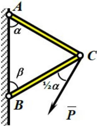
$P = 4 \text{ кН}$ ,  $\alpha = 60^\circ$ ,  $\beta = 60^\circ$ . Определить усилия в
