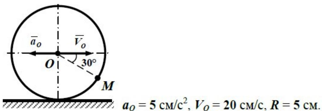
Колесо катится без скольжения, определить скорость и ускорение точки
