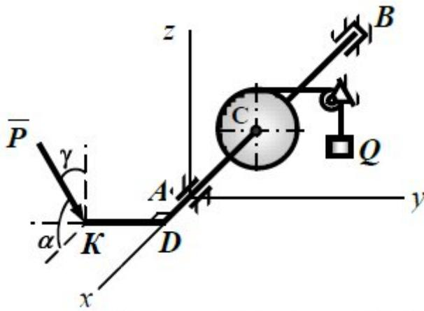
Определить реакции связей и величину силы  $\bar{P}$ , удерживающей конструкцию в равновесии. Трос, на котором подвешен груз  $Q$  весом 1800 Н, сходит с барабана  $C$  по касательной и параллелен оси  $Ay$ . Углы:  $\alpha = 90^\circ$ ,  $\gamma = 30^\circ$ ,  $AD = \frac{1}{4}AB$ ,  $AC = \frac{3}{4}AB$ ,  $KD = 1,5R$ ,  $KD \parallel Ay$ .
