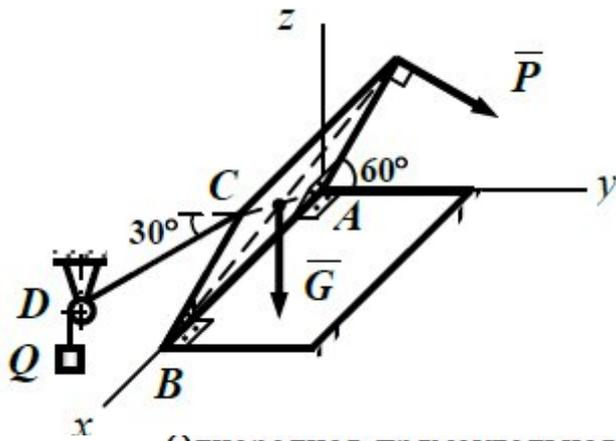
Однородная прямоугольная плита весом  $2 \text{ кН}$  закреплена и нагружена, как показано на рисунке. Определить величину силы  $P$  и реакции связей, если  $Q = 5 \text{ кН}$ . Участок  $CD$  нити и вектор силы  $\bar{P}$  перпендикулярны оси  $Ax$ .
