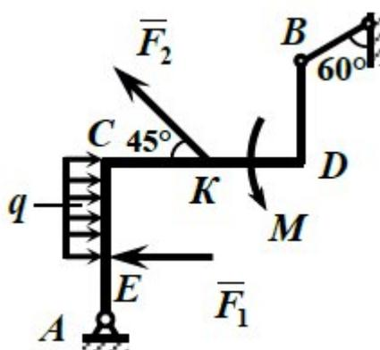
Ломаный стержень закреплен в точке  $A$  шарнирно, а в точке  $B$  невесомым стержнем. На стержень действует пара сил с моментом  $M = 4$  кН·м, равномерно распределенная нагрузка с интенсивностью  $q = 0,3$  кН/м и две сосредоточенные силы  $F_1 = 4$  кН и  $F_2 = 7$  кН. Определить реакции связей, если  $AE = a$ ,  $EC = CK = KD = DB = 2a$  и  $a = 0,4$  м.
