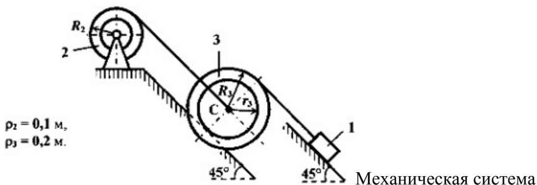
состоит из груза 1, блока 2 и катка 3, соединённых между собой невесомыми нерастяжимыми нитями. Система приводится в движение из состояния покоя силами тяжести тел, входящих в систему. Коэффициент трения скольжения между грузом 1 и плоскостью  $f = 0,1$ . Каток 3 катится без скольжения, коэффициент трения качения  $f_k = 0,8$  мм. В подшипниках блока 2 действует постоянный момент сил сопротивления  $M_2 = 2$  Н·м.
