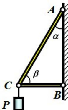
$P = 10 \text{ кН}$ ,  $\alpha = 30^\circ$ ,  $\beta = 60^\circ$ . Определить усилия в стержнях
