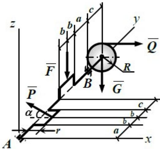
Определить величину силы  $P$  и значение угла  $\alpha$ , при которых составляющая  $X_A$  реакции шарнира равна нулю. Для полученных значений силы  $P$  и угла  $\alpha$  найти остальные реакции связей, если  $Q = 2$  кН,  $G = 3$  кН,  $F = 4$  кН,  $a = 0,4$  м,  $b = 0,1$  м,  $c = 0,2$  м,  $R = 0,3$  м,  $r = 0,1$  м.
