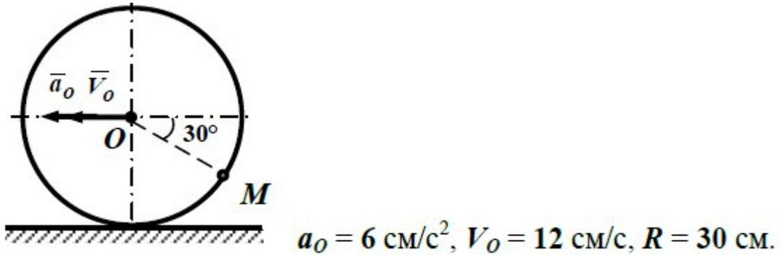
Колесо катится без скольжения, определить скорость и ускорение точки М.
