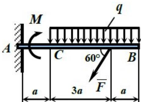
Определить реакции заделки консольной балки  $AB$ , находящейся под действием равномерно распределенной нагрузки с интенсивностью  $q = 10$  кН/м, сосредоточенной силы  $F = 40$  кН и пары сил с моментом  $M = 25$  кН·м, если  $a = 1$  м.
