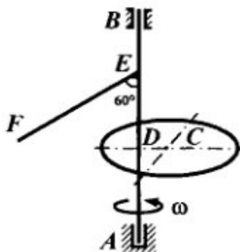
Невесомый вал  $AB$  вращается с постоянной угловой скоростью  $\omega = 2$  рад/с. К валу прикреплены сплошной однородный диск массой  $5$  кг и радиусом  $0,3$  м, а также однородный тонкий стержень  $EF$  массой  $3$  кг. Плоскость диска перпендикулярна валу, а стержень и прямая  $DC$  лежат в одной плоскости. Определить статические, динамические и полные реакции связей вала, если  $AD = DE = BE = 0,5$  м,  $EF = 0,6$  м,  $DC = 0,2$  м.
