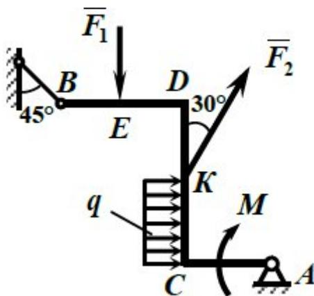
Ломаный стержень закреплен в точке  $A$  шарнирно, а в точке  $B$  невесомым стержнем. На балку действует пара сил с моментом  $M = 6$  кН·м, равномерно распределенная нагрузка с интенсивностью  $q = 1,5$  кН/м и две сосредоточенные силы  $F_1 = 7$  кН и  $F_2 = 10$  кН. Определить реакции связей, если  $BE = ED = 1,5a$ ,  $DK = KC = CA = 2a$  и  $a = 0,4$  м.
