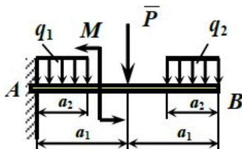
Определить реакции заделки консольной балки  $AB$ , находящейся под действием равномерно распределенной нагрузки с интенсивностью  $q_1 = 1,2$  кН/м и  $q_2 = 0,8$  кН/м, сосредоточенной силы  $P = 0,6$  кН и пары сил с моментом  $M = 1,5$  кН·м, если  $a_1 = 3$  м,  $a_2 = 2$  м.
