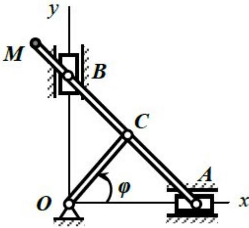
Звено  $OC$  механизма движется по закону  $\varphi = \frac{\pi t}{6}$  ( $\varphi$  – рад,  $t$  – с).
