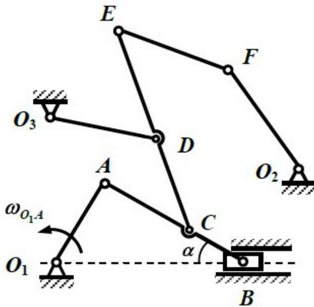
$O_1A = 21$  см,  $\omega_{O_1A} = 2$  рад/с,  $\angle O_1AB = 90^\circ$ ,  $\alpha = 30^\circ$ .
