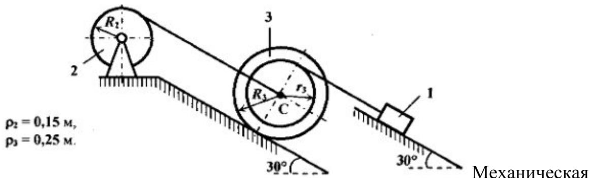
система состоит из груза 1, блока 2 и катка 3, соединённых между собой невесомыми нерастяжимыми нитями. Система приводится в движение из состояния покоя силами тяжести тел, входящих в систему. Коэффициент трения скольжения между грузом 1 и плоскостью  $f = 0,1$ . Каток 3 катится без скольжения, коэффициент трения качения  $f_k = 0,8$  мм. В подшипниках блока 2 действует постоянный момент сил сопротивления  $M_2 = 3$  Н·м.
