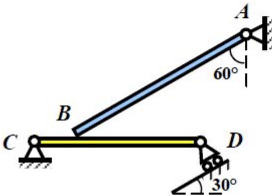
Однородный брус  $AB$  весом  $400\text{ Н}$  опирается на однородную балку  $CD$  весом  $70\text{ Н}$ . Определить реакции опор, если  $AB = 2\text{ м}$ ,  $BD = 2\text{ м}$ ,  $CB = 0,3\text{ м}$ .
