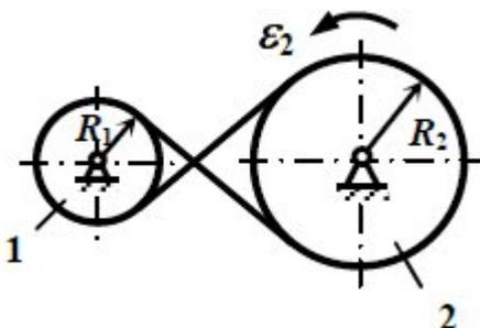
Шкив 1 радиусом  $R_1 = 0,4$  м приводится в движение из состояния покоя бесконечным ремнем от шкива 2 радиусом  $R_2 = 0,8$  м, угловое ускорение которого равно  $0,4\pi$  рад/с<sup>2</sup>. Пренебрегая скольжением ремня по шкивам, определить время, по истечении которого шкив 1 будет делать 300 оборотов в минуту. Вычислить скорость точек обода шкива 1.
