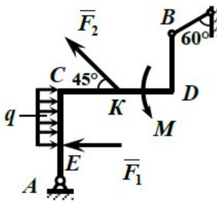
Ломаный стержень закреплен в точке  $A$  шарнирно, а в точке  $B$  невесомым стержнем. На стержень действует пара сил с моментом  $M = 4$  кН·м, равномерно распределенная нагрузка с интенсивностью  $q = 0,3$  кН/м и две сосредоточенные силы  $F_1 = 4$  кН и  $F_2 = 7$  кН. Определить реакции связей, если  $AE = a$ ,  $EC = CK = KD = DB = 2a$  и  $a = 0,4$  м.
