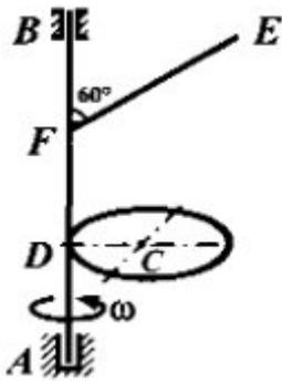
Невесомый вал  $AB$  вращается с постоянной угловой скоростью  $\omega = 3$  рад/с. К валу прикреплены сплошной однородный диск массой  $6$  кг и радиусом  $0,2$  м, а также однородный тонкий стержень  $EF$  массой  $3$  кг и длиной  $0,8$  м. Плоскость диска перпендикулярна валу, а стержень и радиус  $DC$  лежат в одной плоскости. Определить статические, динамические и полные реакции связей вала, если  $AD = DF = FB = 0,4$  м.
