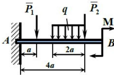
Определить реакции заделки консольной балки  $AB$ , находящейся под действием равномерно распределенной нагрузки с интенсивностью  $q = 0,6$  кН/м, сосредоточенных сил  $P_1 = 2$  кН и  $P_2 = 1,3$  кН и пары сил с моментом  $M = 0,5$  кН·м, если  $a = 1,5$  м.
