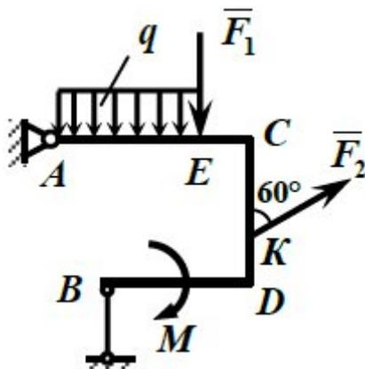
Жесткая рама закреплена в точке  $A$  шарнирно, а в точке  $B$  прикреплена к невесомому стержню. На раму действует пара сил с моментом  $M = 10$  кН·м, равномерно распределенная нагрузка с интенсивностью  $q = 0,3$  кН/м и две сосредоточенные силы  $F_1 = 3$  кН и  $F_2 = 5$  кН. Определить реакции связей, если  $EC = KD = a$ ,  $CK = 2a$ ,  $AE = DB = 3a$  и  $a = 0,5$  м.
