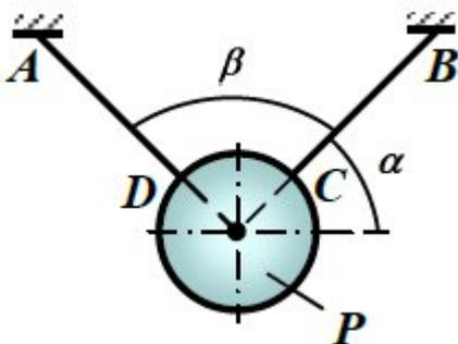
$P = 40 \text{ кН}, \alpha = 45^\circ, \beta = 90^\circ.$  Определить усилия в стержнях графическим и аналитическим способами.
