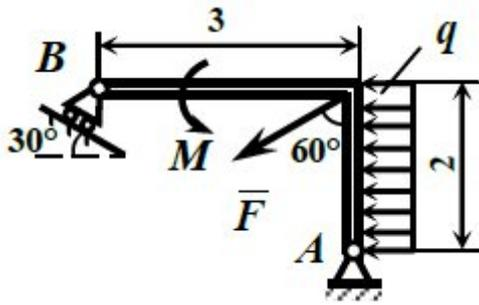
Определить реакции опор  $A$  и  $B$  ломаного стержня, находящегося под действием равномерно распределенной нагрузки с интенсивностью  $q = 8$  кН/м, сосредоточенной силы  $F = 10,2$  кН и пары сил с моментом  $M = 12$  кН·м. Размеры на рисунке даны в метрах.
