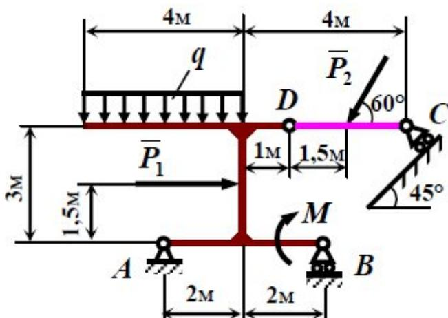
Найти реакции опор и давление в промежуточном шарнире составной конструкции, если  $P_1 = 12\text{ кН}$ ,  $P_2 = 6\text{ кН}$ ,  $M = 18\text{ кН}\cdot\text{м}$ ,  $q = 4\text{ кН/м}$ .
