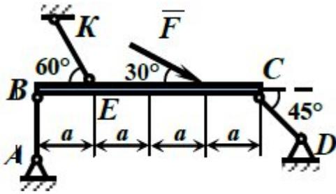
Однородная балка  $BC$  весом  $400$  Н удерживается в равновесии при помощи невесомых стержней  $AB$ ,  $CD$  и  $EK$ . Определить их реакции, если  $F = 150$  Н.
