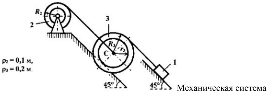
состоит из груза 1, блока 2 и катка 3, соединённых между собой невесомыми нерастяжимыми нитями. Система приводится в движение из состояния покоя силами тяжести тел, входящих в систему. Коэффициент трения скольжения между грузом 1 и плоскостью  $f = 0,1$ . Каток 3 катится без скольжения, коэффициент трения качения  $f_k = 0,8$  мм. В подшипниках блока 2 действует постоянный момент сил сопротивления  $M_2 = 2$  Н·м.
