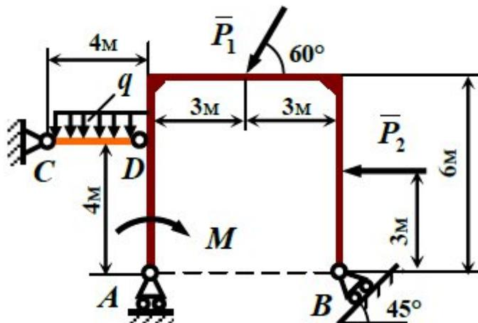
Найти реакции опор и давление в промежуточном шарнире составной конструкции, если  $P_1 = 20$  кН,  $P_2 = 5$  кН,  $M = 20$  кН·м,  $q = 10$  кН/м.
