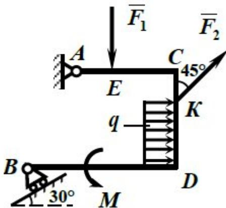
Жесткая рама закреплена в точке  $A$  шарнирно, а в точке  $B$  прикреплена к шарнирной опоре на катках. На раму действует пара сил с моментом  $M = 10$  кН·м, равномерно распределенная нагрузка с интенсивностью  $q = 2$  кН/м и две сосредоточенные силы  $F_1 = 3$  кН и  $F_2 = 5$  кН. Определить реакции связей, если  $AE = CK = a$ ,  $AC = 3a$ ,  $KD = 2a$ ,  $BD = 4a$  и  $a = 0,8$  м.
