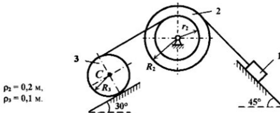
Механическая система состоит из груза 1, блока 2 и катка 3, соединённых между собой невесомыми нерастяжимыми нитями. Система приводится в движение из состояния покоя силами тяжести тел, входящих в систему.
