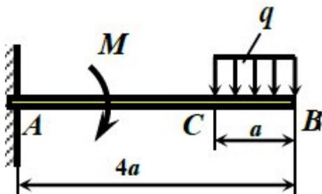
Определить реакции заделки консольной балки  $AB$ , находящейся под действием равномерно распределенной нагрузки с интенсивностью  $q = 2,3$  кН/м и пары сил с моментом  $M = 3,5$  кН·м, если,  $a = 2$  м.
