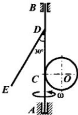
Вал  $AB$  вращается с постоянной угловой скоростью  $\omega = 2$  рад/с. К валу прикреплены сплошной однородный диск радиусом  $0,2$  м и массой  $5$  кг, а также однородный тонкий стержень  $DE$  длиной  $0,6$  м и массой  $3$  кг. Диск и стержень лежат в одной плоскости. Определить статические, динамические и полные реакции связей вала, если  $AC = CD = DB = 0,4$  м.
