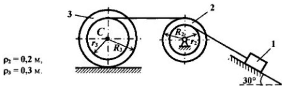
Механическая система состоит из груза 1, блока 2 и катка 3, соединённых между собой невесомыми нерастяжимыми нитями. Система приводится в движение из
