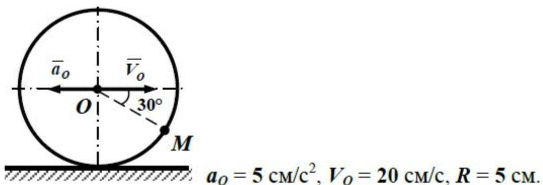
Колесо катится без скольжения, определить скорость и ускорение точки М.
