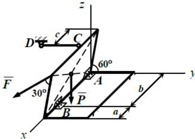
Однородная прямоугольная плита весом  $2$  кН закреплена, как показано на рисунке. Определить величину силы  $F$ , при которой усилие в стержне  $CD$  равно нулю. Для полученного значения силы  $F$  найти реакции остальных связей, если  $a = 0,2$  м,  $b = 1,0$  м,  $c = 0,4$  м,  $\vec{F} \perp Ax$ ,  $CD \parallel Ay$ .
