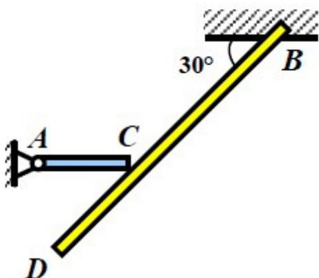
Однородный горизонтальный стержень  $AC$ , вес которого равен 180 Н, свободно опирается в точке  $C$  на балку  $BD$  весом 200 Н. Определить реакции опор, если  $BD = 8$  м,  $CD = \frac{1}{4}BD$ .
