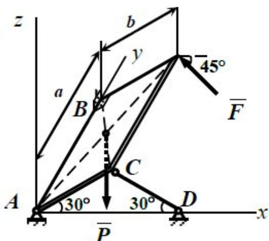
Однородная прямоугольная плита весом 4 кН закреплена, как показано на рисунке. Определить величину силы  $F$ , при которой усилие в стержне  $CD$  равно нулю. Для полученного значения силы  $F$  найти реакции остальных связей, если  $\bar{F} \perp Ay$ .
