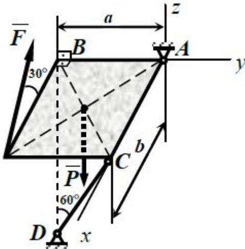
Однородная прямоугольная плита весом 1 кН закреплена, как показано на рисунке. Определить величину силы  $F$ , при которой усилие в стержне  $CD$  равно нулю. Для полученного значения силы  $F$  найти реакции остальных связей, если:  $a = 0,6$  м,  $b = 0,8$  м,  $\bar{F} \perp Ay$ .
