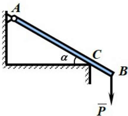
$P = 2 \text{ кН}$ ,  $AB = 2,5 \text{ м}$ ,  $AC = 2 \text{ м}$ ,  $\alpha = 30^\circ$ .
