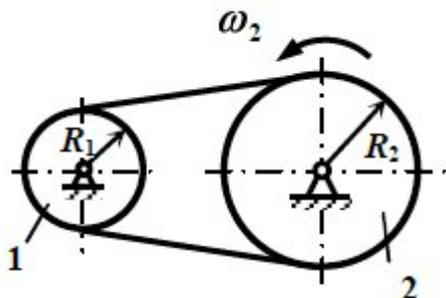
Шкив 2 радиусом  $R_2 = 0,75$  м приводится в движение из состояния покоя бесконечным ремнем от шкива 1 радиусом  $R_1 = 0,3$  м, угловое ускорение которого равно  $0,004\pi$  рад/с<sup>2</sup>. Пренебрегая скольжением ремня по шкивам, определить время, по истечении которого, шкив 2 будет делать 300 оборотов в минуту. Определить скорости точек обода шкива 1.
