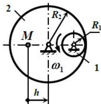
Колесо 1 зубчатой передачи вращается с постоянной угловой скоростью равной  $30\pi$  рад/с. Определить скорость и ускорение точки  $M$  колеса 2, находящейся на расстоянии  $h = R_1$  от оси вращения, если считать, что радиусы колес  $R_1 = 0,05$  м,  $R_2 = 0,15$  м.
