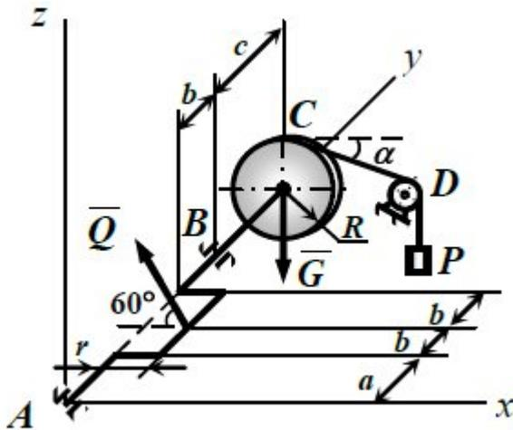
Определить величину силы тяжести груза  $P$  и значение угла  $\alpha$  при которых составляющая  $Z_B$  реакции шарнира равна нулю. Для полученных значений силы  $P$  и угла  $\alpha$  найти остальные реакции связей, если:  $Q = 10 \text{ кН}$ ,  $G = 1 \text{ кН}$ ,  $a = 0,8 \text{ м}$ ,  $b = 0,2 \text{ м}$ ,  $c = 0,6 \text{ м}$ ,  $R = 0,4 \text{ м}$ ,  $r = 0,2 \text{ м}$ ,  $CD \perp Ay$ .
