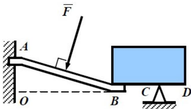
Однородная плита весом  $80\text{ Н}$ , поставленная на край  $B$  балки  $AB$ , подпирается точечной опорой  $C$ . Перпендикулярно к балке, в ее середине, приложена сила  $F = 100\text{ Н}$ . Пренебрегая весом балки, определить реакции заделки  $A$  и опоры  $C$ , если  $AO = 25\text{ см}$ ,  $OB = 60\text{ см}$ ,  $BC = 40\text{ см}$ ,  $CD = 10\text{ см}$ .
