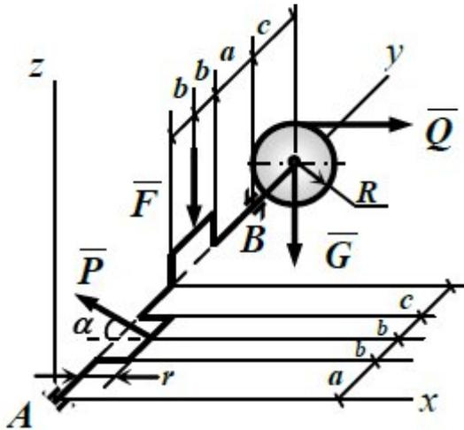
Определить величину силы  $P$  и значение угла  $\alpha$ , при которых составляющая  $X_A$  реакции шарнира равна нулю. Для полученных значений силы  $P$  и угла  $\alpha$  найти остальные реакции связей, если  $Q = 2$  кН,  $G = 3$  кН,  $F = 4$  кН,  $a = 0,4$  м,  $b = 0,1$  м,  $c = 0,2$  м,  $R = 0,3$  м,  $r = 0,1$  м.
