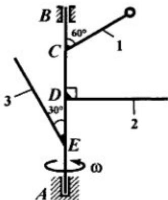
Вал  $AB$  вращается с постоянной скоростью  $\omega = 10$  рад/с. К валу прикреплены три стержня, лежащие в одной плоскости. Длины стержней:  $l_1 = 0,4$  м,  $l_2 = 0,6$  м,  $l_3 = 0,8$  м. На конце первого стержня, массой которого пренебрегаем, закреплён точечный груз массой  $m_1 = 2$  кг. Два других стержня, массами  $m_2 = 6$  кг и  $m_3 = 8$  кг, считать однородными тонкими. Определить статические, динамические и полные реакции связей вала, если  $AE = ED = DC = CB = 0,5$  м.
