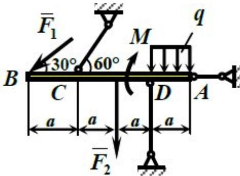
Определить реакции заделки консольной балки  $AB$ , находящейся под действием равномерно распределенной нагрузки с интенсивностью  $q = 0,6$  кН/м, сосредоточенных сил  $P_1 = 2$  кН и  $P_2 = 1,3$  кН и пары сил с моментом  $M = 0,5$  кН·м, если  $a = 1,5$  м.
