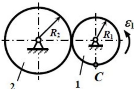
Колесо 1 зубчатой передачи вращается с угловым ускорением, равным  $2\pi$  рад/с<sup>2</sup>. Определить угловую скорость колеса 1 и ускорение точки  $C$  в тот момент, когда колесо 2 вращается с угловой скоростью соответствующей 600 об/мин, если радиусы колес  $R_1 = 0,4$  м,  $R_2 = 0,8$  м.
