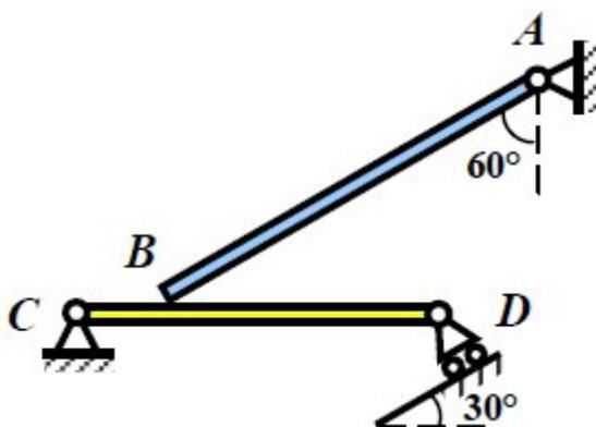
Однородный брус  $AB$  весом  $400$  Н опирается на однородную балку  $CD$  весом  $70$  Н. Определить реакции опор, если  $AB = 2$  м,  $BD = 2$  м,  $CB = 0,3$  м.
