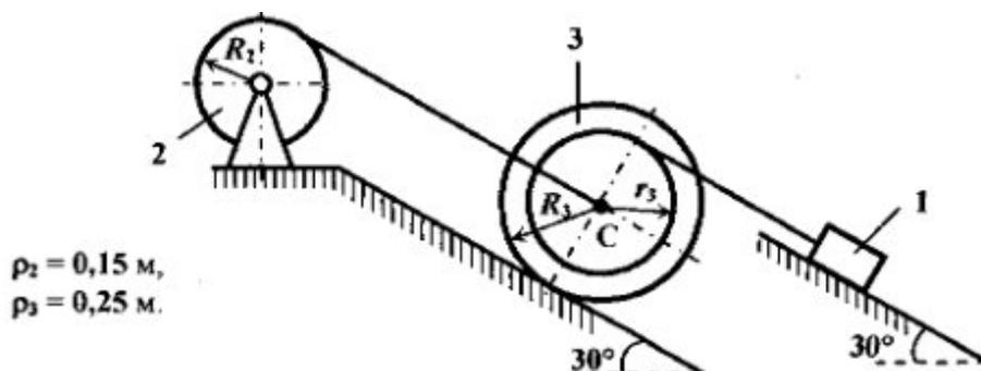
Механическая система состоит из груза 1, блока 2 и катка 3, соединённых между собой невесомыми нерастяжимыми нитями. Система приводится в движение из состояния покоя силами тяжести тел, входящих в систему.
