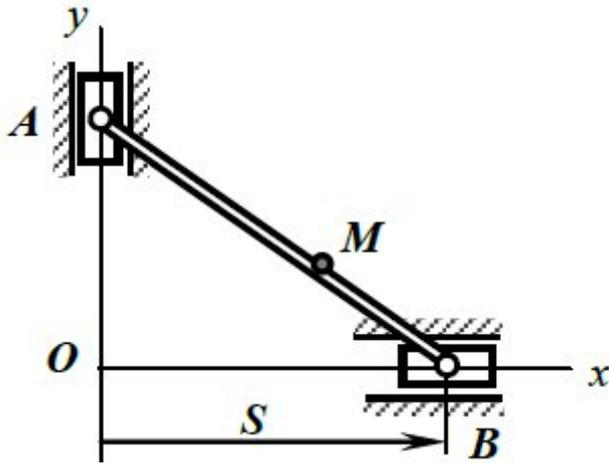
Точка В механизма движется по закону  $S = 0,45\sin 3\pi t$  ( $S$  – м,  $t$  – с). Построить положение звеньев механизма в моменты времени  $t_0 = 0$ ,  $t_1 = \frac{1}{18}$  с и  $t_2 = \frac{1}{6}$  с. Написать уравнения движения точек  $A$  и  $M$  механизма в координатной форме и найти уравнение траектории точки  $M$ . Определить скорости и ускорения точек  $A$  и  $M$ , а также радиус кривизны траектории в точке  $M$  при  $t_1 = \frac{1}{18}$  с, если  $AB = 0,45$  м,  $AM = 0,3$  м.
