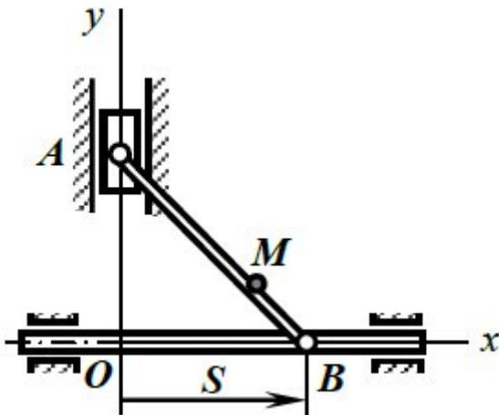
Точка В механизма движется по закону  $S = 0,6\sin\pi t$  ( $S$  – м,  $t$  – с). Построить положение звеньев механизма в моменты времени  $t_0 = 0$ ,  $t_1 = \frac{1}{6}$  с,  $t_2 = \frac{1}{2}$  с. Написать уравнения движения точек  $A$  и  $M$  механизма в координатной форме и найти уравнение траектории точки  $M$ . Определить скорости и ускорения точек  $A$  и  $M$ , а также радиус кривизны траектории в точке  $M$  при  $t_1 = \frac{1}{6}$  с, если  $AB = 0,6$  м,  $AM = 0,45$  м.
