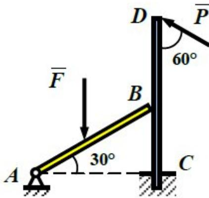
Стержень  $AB$  свободно опирается на вертикальный стержень  $CD$  длиной 1,8 м, жестко заделанный в основание. К середине стержня  $AB$  приложена вертикальная сила  $F = 2$  кН, а в точке  $D$  стержня  $CD$  сосредоточена сила  $P = 1$  кН. Определить реакции опор, пренебрегая весом стержней, если  $BC = BD$ .
