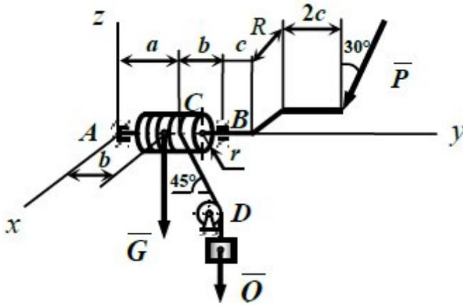
Определить реакции связей и величину силы  $P$ , при равновесии ворота, если  $Q = 4$  кН,  $G = 1$  кН,  $a = 0,25$  м,  $b = 0,2$  м,  $c = 0,08$  м,  $R = 0,15$  м,  $r = 0,1$  м,  $\bar{P} \perp Ax$ ,  $CD \perp Ax$ .
