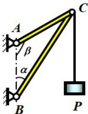
$P = 2 \text{ кН}$ ,  $\alpha = 15^\circ$ ,  $\beta = 135^\circ$ . Определить усилия в
