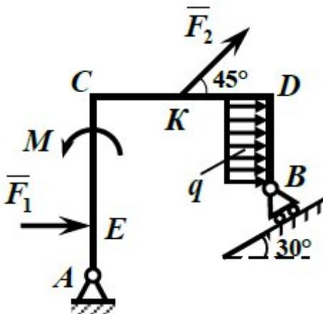
Жесткая рама закреплена в точке  $A$  шарнирно, а в точке  $B$  прикреплена к шарнирной опоре на катках. На раму действует пара сил с моментом  $M = 4$  кН·м, равномерно распределенная нагрузка с интенсивностью  $q = 0,5$  кН/м и две сосредоточенные силы  $F_1 = 4$  кН и  $F_2 = 6$  кН. Определить реакции связей, если  $CK = KD = DB = 2a$ ,  $AE = a$ ,  $EC = 3a$  и  $a = 0,4$  м.
