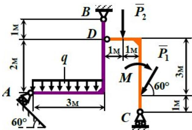
Найти реакции опор и давление в промежуточном шарнире составной конструкции, если  $P_1 = 30$  кН,  $P_2 = 8$  кН,  $M = 26$  кН·м,  $q = 2$  кН/м.
