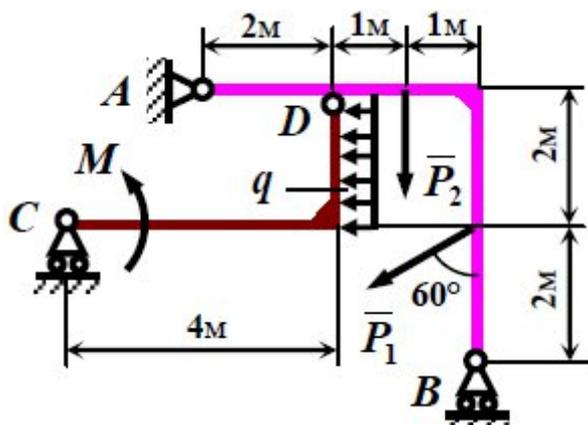
Найти реакции опор и давление в промежуточном шарнире составной конструкции.  $P_1 = 8$  кН,  $P_2 = 10$  кН,  $M = 25$  кН·м,  $q = 2$  кН/м.
