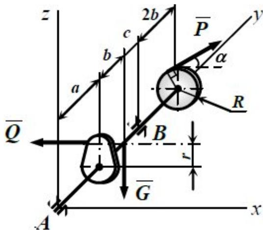
Определить величину силы  $P$  и значение угла  $\alpha$ , при которых составляющая  $X_B$  реакции шарнира равна нулю. Для полученных значений силы  $P$  и угла  $\alpha$  найти остальные реакции связей, если  $Q = 4$  кН,  $G = 5$  кН,  $a = 0,4$  м,  $b = 0,2$  м,  $c = 0,1$  м,  $R = 0,3$  м,  $r = 0,2$  м,  $\bar{P} \perp Ay$ .
