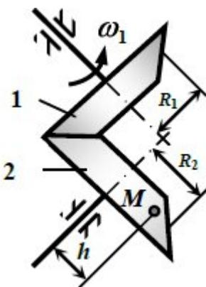
Зубчатое колесо 1 радиусом  $R_1 = 0,1$  м конической пары вращается с постоянной угловой скоростью  $30\pi$  рад/с. Определить скорость и ускорение точки  $M$ , лежащей на колесе 2 радиусом  $R_2 = 0,15$  м на расстоянии  $h = R_1$  от оси вращения.
