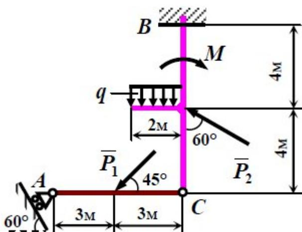
Найти реакции опор и давление в промежуточном шарнире составной конструкции, если  $P_1 = 10$  кН,  $P_2 = 7$  кН,  $M = 21$  кН·м,  $q = 3,5$  кН/м.
