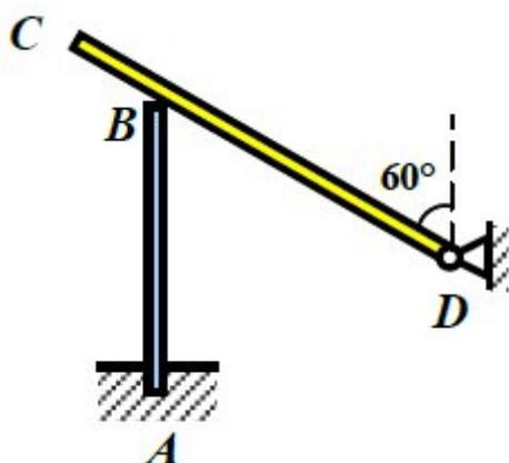
Однородный стержень  $CD$  весом  $346$  Н опирается на вертикальную стойку  $AB$  весом  $123$  Н. Определить реакции опор, если  $BD = 2$  м,  $BC = 1$  м,  $AB = 2$  м.
