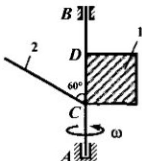
Вал  $AB$  вращается с постоянной скоростью  $\omega = 5$  рад/с. К валу в одной плоскости прикреплены однородная квадратная пластинка 1 массой  $10$  кг со стороной  $0,5$  м и однородный тонкий стержень 2 массой  $3$  кг и длиной  $1$  м. Определить статические, динамические и полные реакции связей вала, если  $AC = CD = DB = 0,5$  м.
