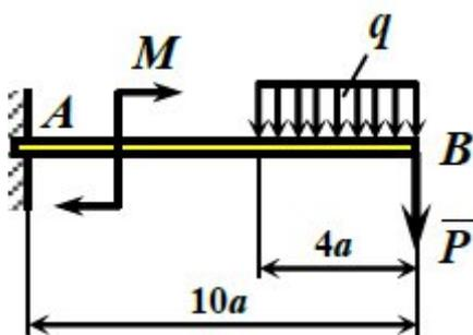
Определить реакции заделки консольной балки  $AB$ , находящейся под действием равномерно распределенной нагрузки с интенсивностью  $q = 1,5 \text{ кН/м}$ , сосредоточенной силы  $P = 3 \text{ кН}$  и пары сил с моментом  $M = 2,5 \text{ кН}\cdot\text{м}$ , если  $a = 0,8 \text{ м}$ .
