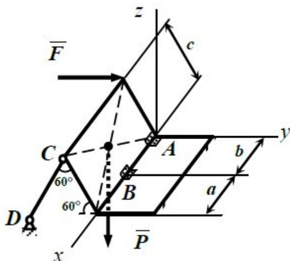
Однородная прямоугольная плита весом  $5 \text{ кН}$  закреплена, как показано на рисунке. Определить величину силы  $\bar{F} \parallel Ay$ , при которой усилие в стержне  $CD \perp Ax$  равно нулю. Для полученного значения силы  $F$  найти реакции остальных связей, если  $a = b = 0,4 \text{ м}$ .
