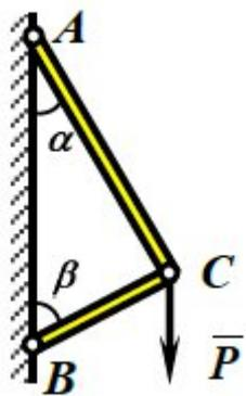
$P = 6 \text{ кН}$ ,  $\alpha = 30^\circ$ ,  $\beta = 60^\circ$ . Определить усилия в стержнях
