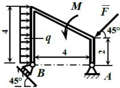
Определить реакции опор  $A$  и  $B$  рамы, находящейся под действием равномерно распределенной нагрузки с интенсивностью  $q = 1,5$  кН/м, сосредоточенной силы  $F = 30$  кН и пары сил с моментом  $M = 10$  кН·м. Размеры на рисунке даны в метрах.
