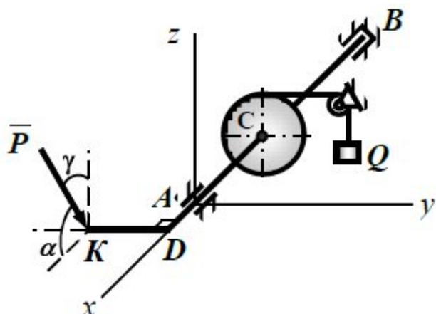
Определить реакции связей и величину силы  $\bar{P}$ , удерживающей конструкцию в равновесии. Трос, на котором подвешен груз  $Q$  весом  $1800 \text{ Н}$ , сходит с барабана  $C$  по касательной и параллелен оси  $Ay$ . Углы:  $\alpha = 90^\circ$ ,  $\gamma = 30^\circ$ ,  $AD = \frac{1}{4}AB$ ,  $AC = \frac{3}{4}AB$ ,  $KD = 1,5R$ ,  $KD \parallel Ay$ .
