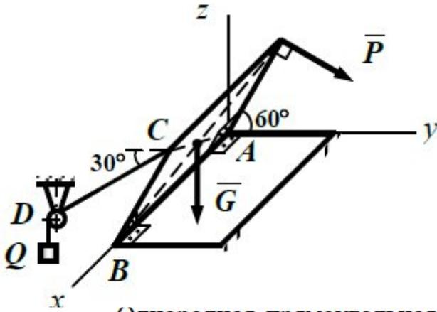
Однородная прямоугольная плита весом  $2 \text{ кН}$  закреплена и нагружена, как показано на рисунке. Определить величину силы  $P$  и реакции связей, если  $Q = 5 \text{ кН}$ . Участок  $CD$  нити и вектор силы  $\vec{P}$  перпендикулярны оси  $Ax$ .
